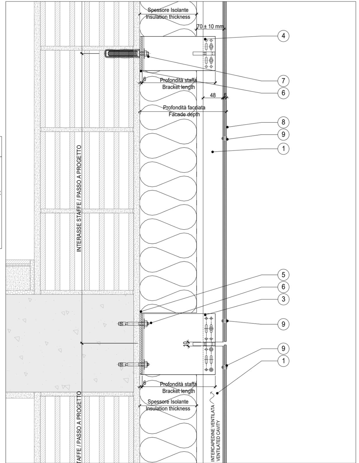
V2 SEZIONE VERTICALE TIPICA - VERTICAL SECTION
