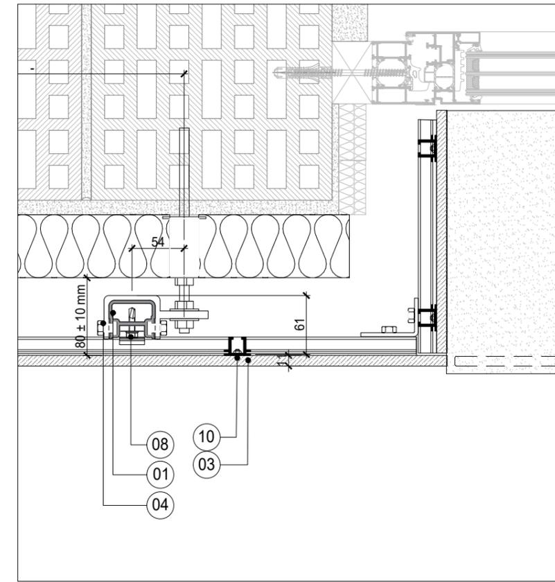
**H3** SEZIONE ORIZZONTALE SPALLA LAMIERA - HORIZONTAL SECTION
