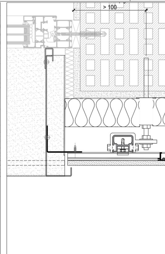
**H3** SEZIONE ORIZZONTALE SPALLA LAMIERA - HORIZONTAL SECTION
