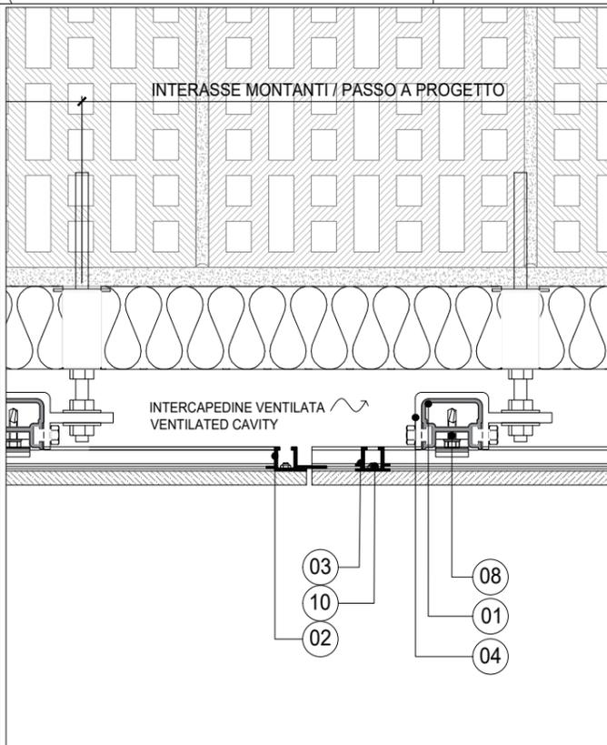
**H1** SEZIONE ORIZZONTALE TIPICA - HORIZONTAL SECTION
