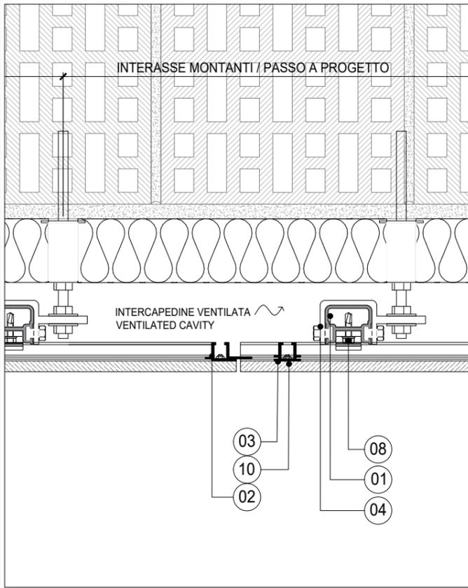
**H1** SEZIONE ORIZZONTALE TIPICA - HORIZONTAL SECTION
