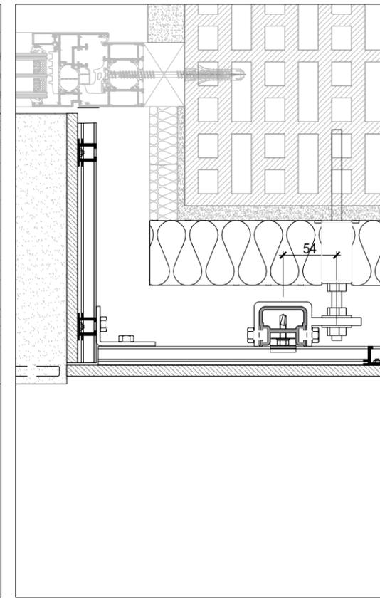
**H4** SEZIONE ORIZZONTALE ANGOLO - HORIZONTAL SECTION
