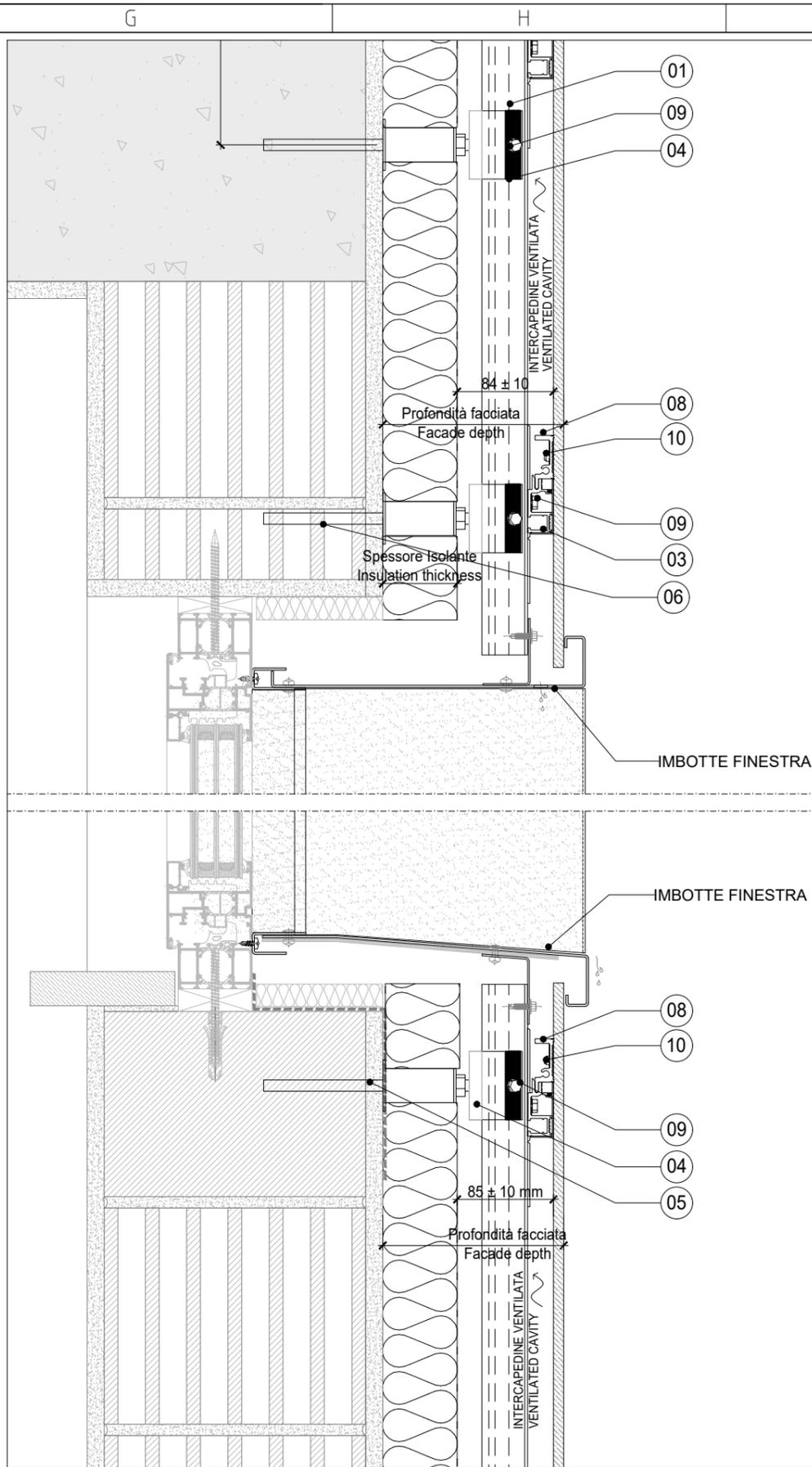
V1 SEZIONE VERTICALE CIELINO E BANCALE IN LAMIERA - VERTICAL SECTION
